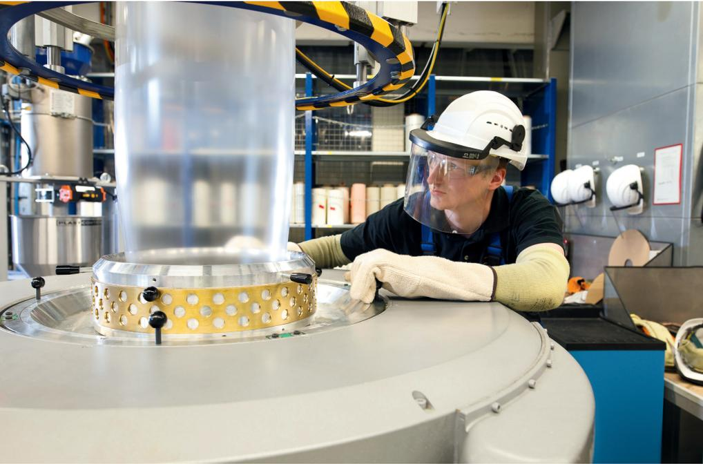
**Bild 1.** Blasfolienanlage von Covestro am Standort Bomlitz: Der Kunststoffhersteller erweitert aktuell dort die Produktion von mehrlagig coextrudierten TPU-Folien, da die Nachfrage danach aus verschiedenen Branchen steigt. © Covestro
